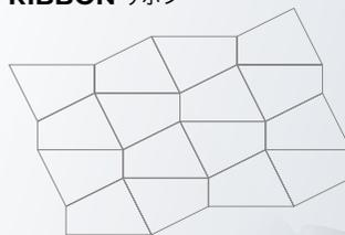
■四面取品の柄貼りや六角形、不等辺四角形、900mm×900mmの施工では、寸法調整や必要に応じてコーキング材による目地仕上げをおすすめします。
