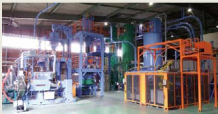
東りはカーペットの主力生産拠点である滋賀東りに「タイルカーペットリサイクルプラント」を導入し、タイルカーペットのパイル層(表面繊維層)とバックキング層(塩ビ樹脂層)を分離することなく、リサイクルチップに加工しています。このリサイクル技術により、タイルカーペット廃材を全てリサイクルチップに加工し、タイルカーペットのバックキング層の一部として再利用することでリサイクル率の向上および産業廃棄物排出量の削減に寄与します。
