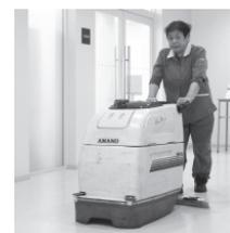
床面積の大きな部位では、洗浄力の優れた自動床面洗浄機を使用していただくことにより効果的です。
