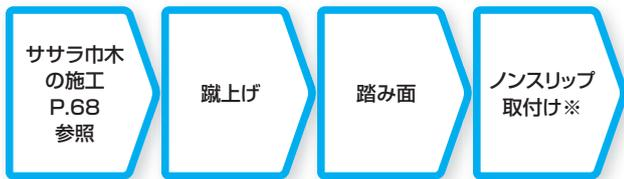
※ノンスリップの形状により踏み面の施工とノンスリップの取付けの順序は逆になることがあります。
